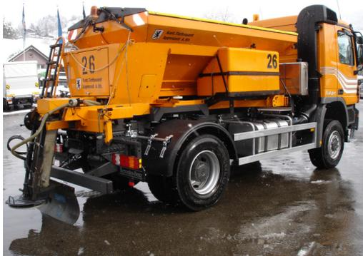
Der erste Aufbau war ein Salzstreuer im Wechselsystem. Der Streuer ist mittels eines einfachen Schnellwechselsystem über der Sattelkupplung montiert. Mit wenigen Handgriffen lässt sich das Fahrzeug vom Winterdienst- zum Baustellenfahrzeug, respektive zum Sattelschlepper umrüsten und kann mit einem Kippauflieger betrieben werden.
